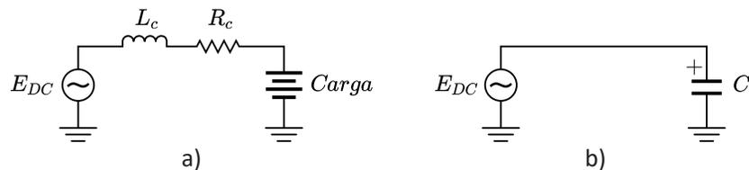
Figura 3.9. Circuitos equivalentes planta I-V convertidor DC/DC: a) Planta de corriente y b) Planta de Tensión.
